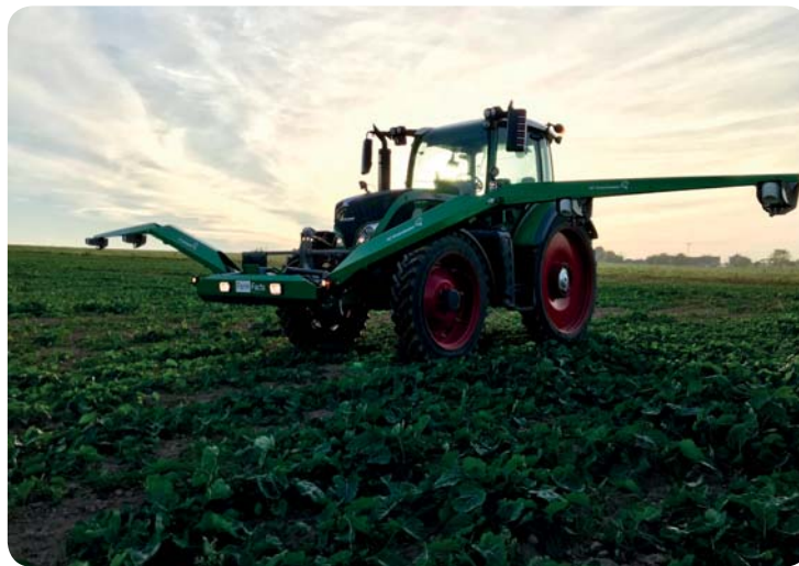
GreenSeeker namontovaný na traktoru je vybaven senzory zjišťujícími obsah chlorofylu, množství rostlin a jejich růstovou fázi
